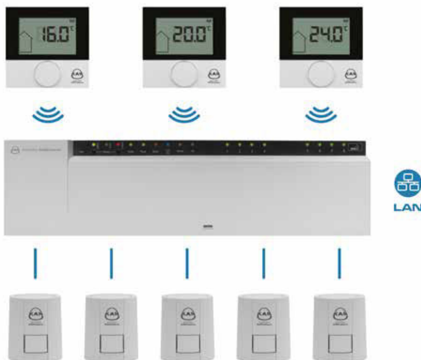
Slika 62. KAN-therm Smart bežični elementi za regulaciju temperature
