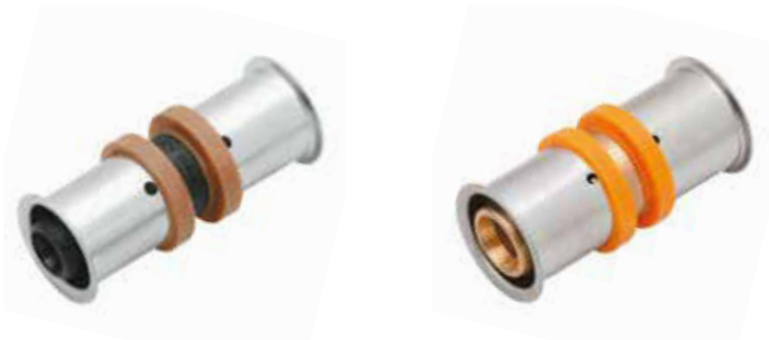
Slika 51. KAN-therm ultraPRESS spojnica za PERTAL, PEXC, PERT, bluePERT i bluePERTAL cijevi 14 × 2, 16 × 2, 20 × 2, 25 × 2,5 mm.
