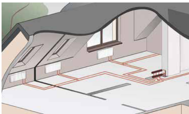
Razdjelnik - T sustav u instalaciji grijanja
