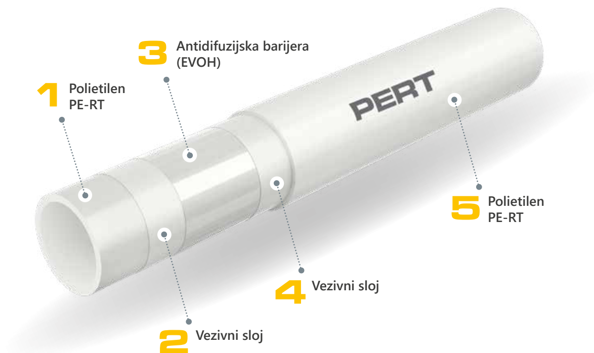
Poprečni presjek PERT cijevi s EVOH slojem
