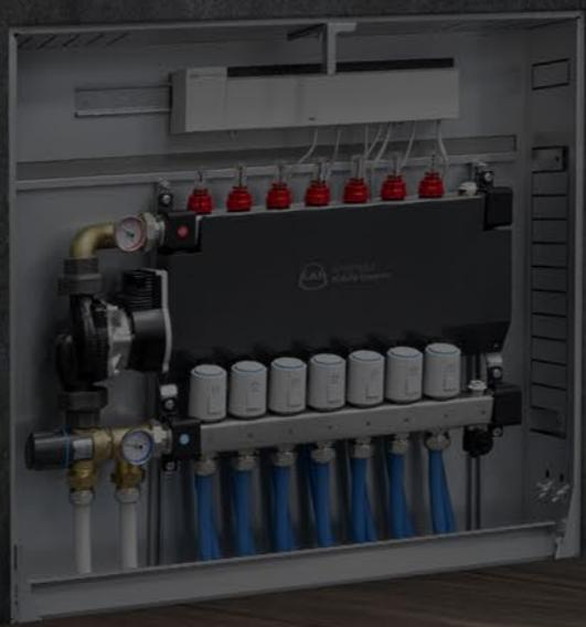
**Inovativna tehnologija proizvodnje i uporaba profila od nehrđajućeg čelika s većim unutarnjim promjerom i manjom debljinom stijenke u odnosu na mesinganu izvedbu čine hidraulički kapacitet KAN-therm InoxFlow razdjelnika gotovo dvostruko većim nego u mesinganoj verziji, bez gubitka mehaničke čvrstoće.**
