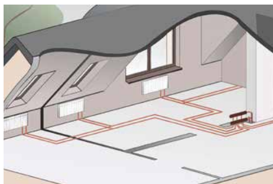
Razdjelnik - T sustav u instalaciji grijanja
