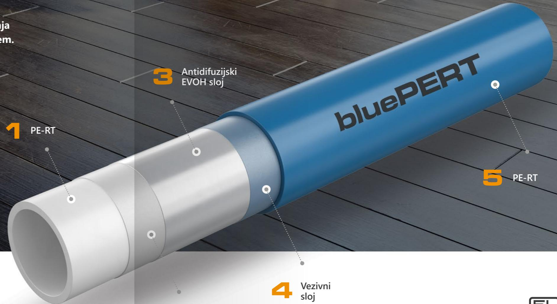
Visokokvalitetne cijevi s EVOH antifuzijskim slojem za izvedbu instalacija površinskog grijanja i hlađenja (klasa primjene 4 prema ISO 10508).
