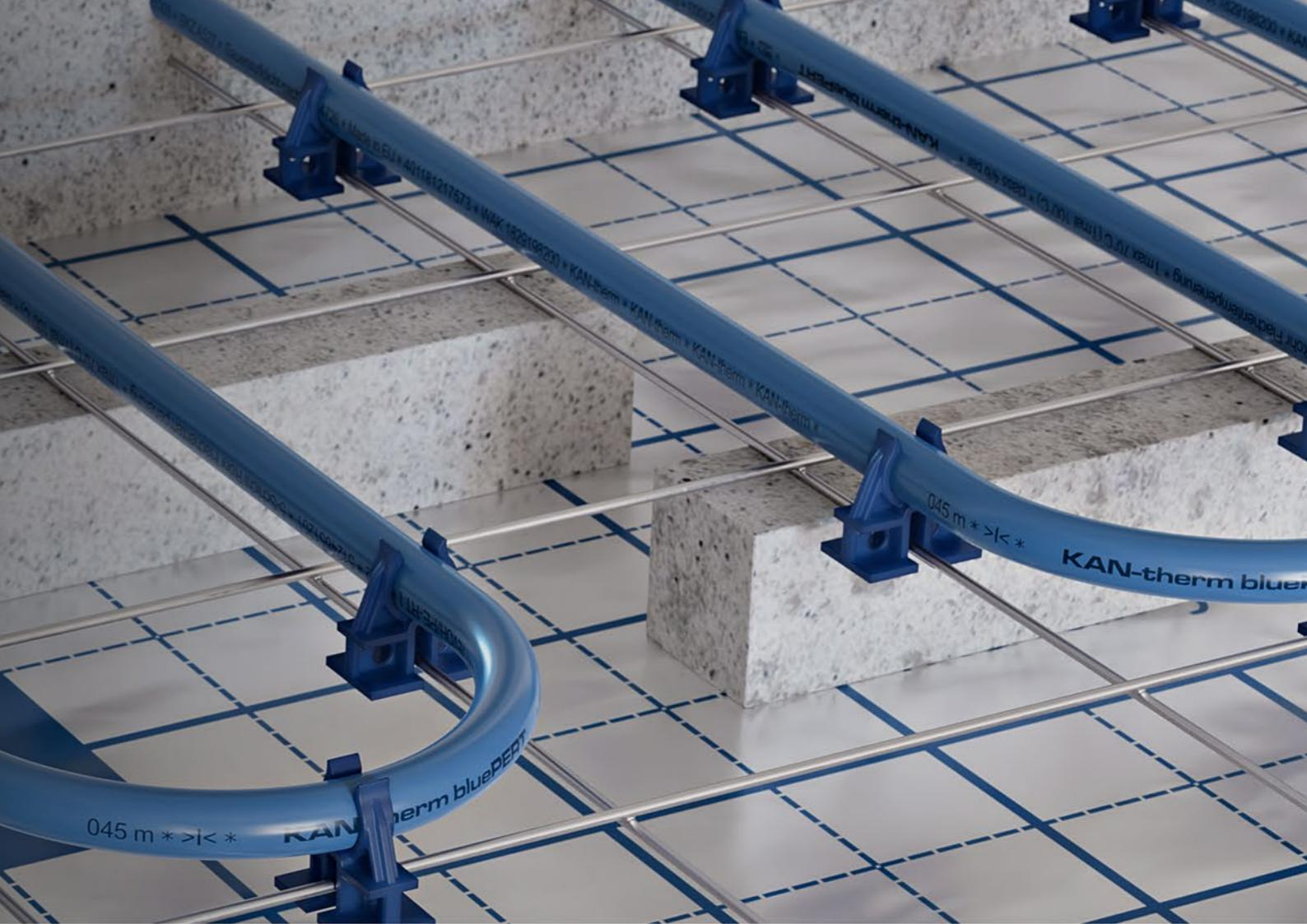
KAN-therm NET je sustav montaže cijevi za grijanje za različite vrste površina – toplinska izolacija na betonsku površinu, izravno na betonsku površinu ili izravno na tlo. Konstrukcija površinskog grijачa može varirati ovisno o primjenjenoj toplinskoj izolaciji (ili njenom nedostatku) kao i vrsti i debljini slojeva na cijevima.
