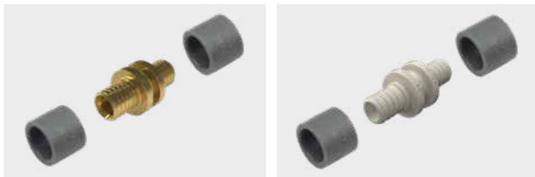
Slika 50. KAN-therm ultraLINE spojnica za PEXC, PERT 2 i PERTAL 2 cijevi, promjera 14 × 2, 16 × 2,2, 20 × 2,8, 25 × 2,5 mm.
