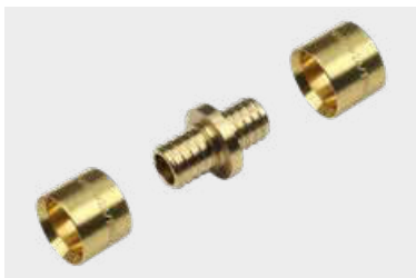
Slika 49. KAN-therm Push spojnica za PEXC, PERT i bluePERT cijevi, promjera 12 × 2, 14 × 2, 18 × 2, 18 × 2,5, 25 × 3,5 mm.
