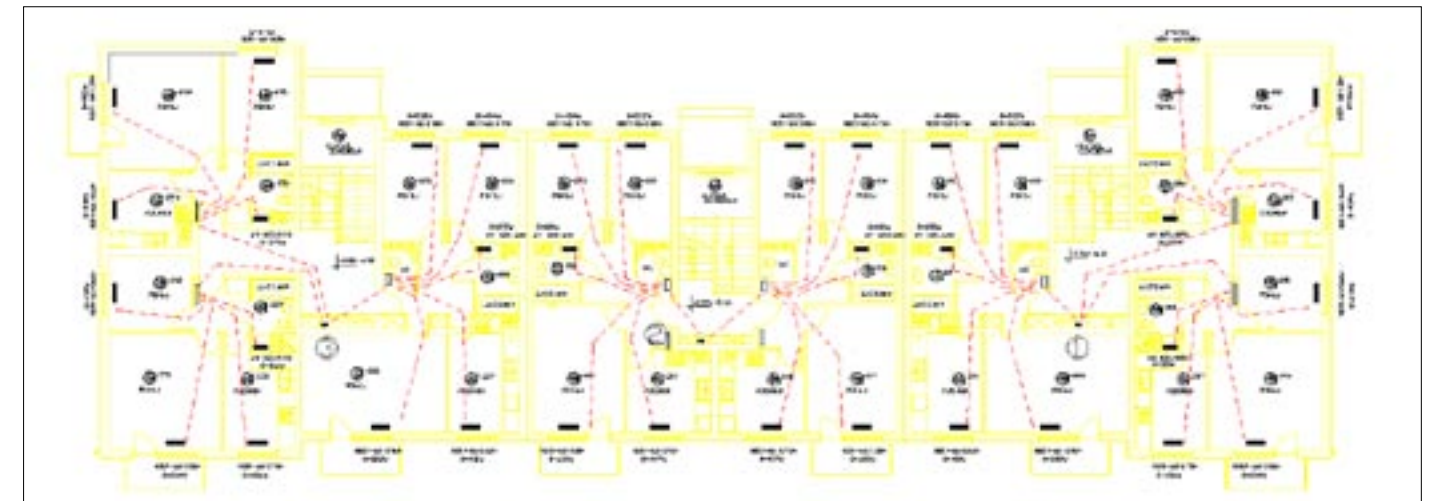
1 Poziomy rozdzielaczowy układ rozprowadzenia od przewodów
